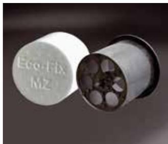
■ **DESCRIPCIÓN** BEYEM CILINDRO H-EPS Y FRESADORA MZ CARGA LIGERA es un kit que consta de un cilindro de EPS de alta densidad para la fijación de objetos ligeros, máximo 15 Kg por pieza, sobre fachadas SATE. Perfecto para sensores, detectores, abrazaderas de tubos, persianas, soportes de lámparas, señales luminosas, etc. Accesorio de fresado MZ para cortar el orificio necesario del material aislante e introducir posteriormente el cilindro de EPS.
