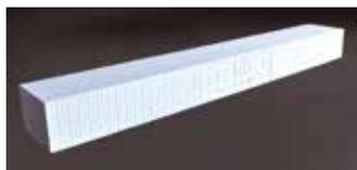
■ **DESCRIPCIÓN** BEYEM BLOQUE H-EPS CARGA LIGERA es un bloque EPS de alta densidad para la fijación de objetos ligeros, máximo 15 Kg por pieza, sobre fachadas SATE. Perfecto para sensores, detectores, abrazaderas de tubos, persianas, soportes de lámparas, señales luminosas, etc. El bloque proporciona marcas cada 10 mm para facilitar el corte en la misma medida del aislamiento.
