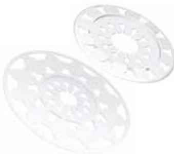
■ **DESCRIPCIÓN** BEYEM DISCO ARANDELA ADICIONAL DE 90 y 140 MW son una extensión de 90 y 140 mm respectivamente, para el plato de 60 mm convencional que tienen los tacos de fijación mecánica para anclar las placas aislantes. Se utilizan para la fijación de placas MW junto con BEYEM TACO DE PLÁSTICO REFORZADO PARA FIJACIÓN MECÁNICA; BEYEM TACO DE ACERO PARA FIJACIÓN MECÁNICA y BEYEM TACO ATORNILLADO DE ACERO PARA FIJACIÓN MECÁNICA.
