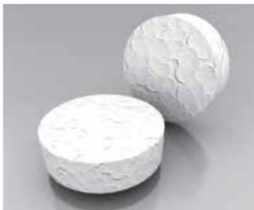
■ **DESCRIPCIÓN** BEYEM TAPÓN DE EPS es una tapa de poliestireno expandido estabilizado que se utiliza para rellenar la cavidad realizada en el panel aislante una vez introducido el anclaje mecánico. Reduce el efecto de los puentes térmicos entre los distintos materiales utilizados en el sistema. Dos diámetros disponibles según accesorio de corte utilizado para hacer el avellanado o embutido de la placa.
