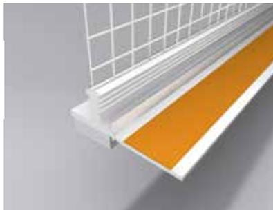
■ **DESCRIPCIÓN** BEYEM PERFIL MARCO VENTANA PVC CON MALLA es un perfil de 6 mm de PVC con malla de fibra de vidrio resistente a los álcalis. Permite conectar el SATE a los marcos de las aberturas de las estructuras de puertas y ventanas sin dejar espacios. Ejecución perfecta gracias a su lengüeta de protección.
