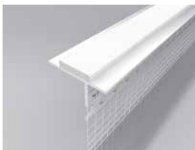
■ **DESCRIPCIÓN** BEYEM PERFIL DE ALFÉIZAR PVC CON MALLA es un perfil de PVC con malla de fibra de vidrio resistente a los álcalis. Se emplea para una ejecución duradera e impermeable del alféizar (alféizares estándar de aluminio, madera, PVC, piedra... o alféizares realizados a medida) creando una unión flexible de éste con el sistema SATE.
