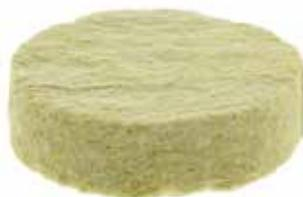
■ **DESCRIPCIÓN** BEYEM TAPÓN MW 65 mm es una tapa de lana de roca de 65 mm de diámetro que se utiliza para rellenar la cavidad realizada en el panel aislante una vez introducido el anclaje mecánico. Reduce el efecto de los puentes térmicos entre los distintos materiales utilizados en el sistema.
