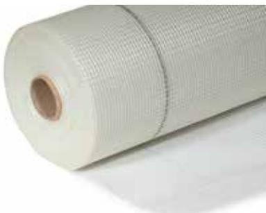
■ **DESCRIPCIÓN** BEYEM MALLA 160 g es una malla de fibra de vidrio resistente a los álcalis, con elevada estabilidad dimensional y alargamiento reducido que está indicada para el refuerzo de la capa base BEYEM ADHETERM en los sistemas SATE.
