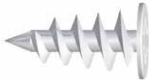
■ **DESCRIPCIÓN** BEYEM ESPIRAL DE CARGA LIGERA es un anclaje en espiral para la fijación de cargas ligeras, máximo 5 kg por pieza, tales como buzones, placas de calles, iluminación e incluso para la fijación de bajantes sobre fachadas SATE. Éstos conectores permiten mantener la continuidad del aislamiento en el punto de unión, no hay puentes térmicos. Están fabricados en nylon de alta calidad que proporciona resistencia a las condiciones climáticas cambiantes.
